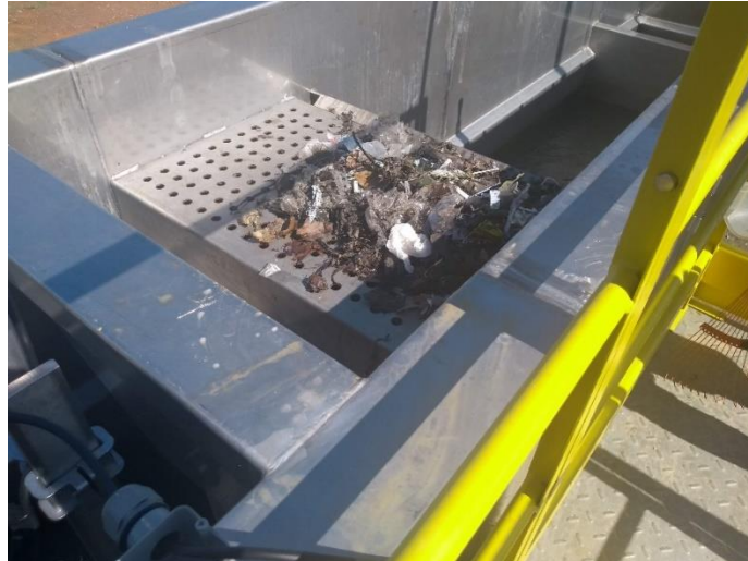
Figura 4. Exemplo de grelha para drenagem dos resíduos retirados do gradeamento.
